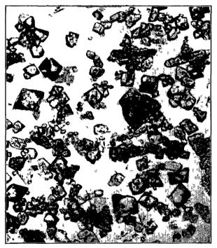
FIGURE 90. Ethylenedinitramine Crystals ( $60 \times$ ).
