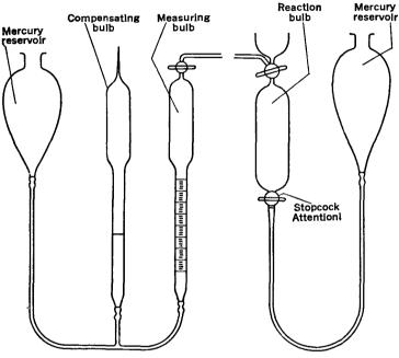
FIGURE 68. Du Pont Nitrometer.
